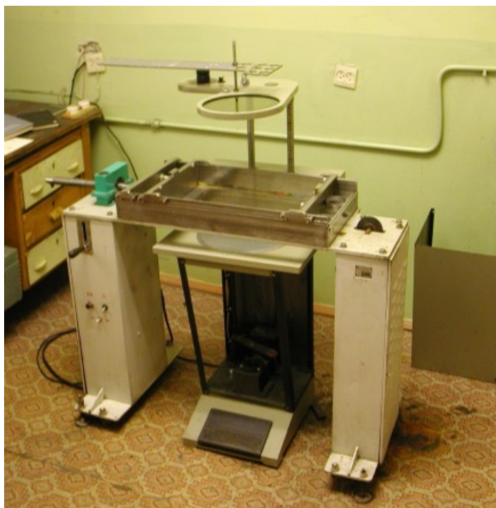
Рис. 16. Установка для моделирования на оптически активных эквивалентных материалах.
