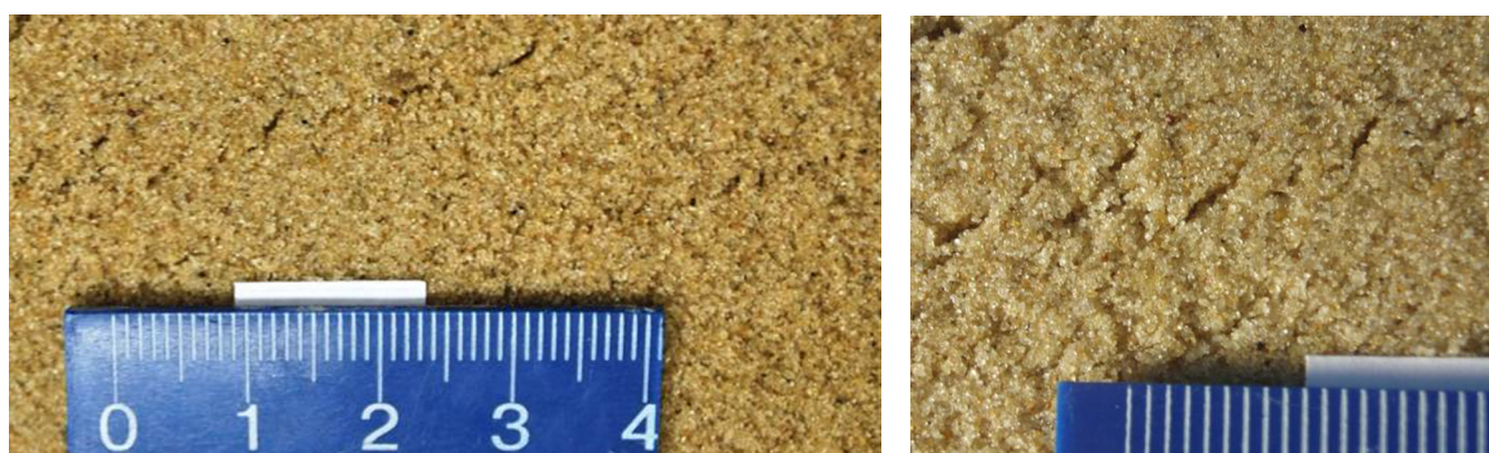
Рис. 14. Формирование сколов Риделя в модели из смеси песка с солидолом.
