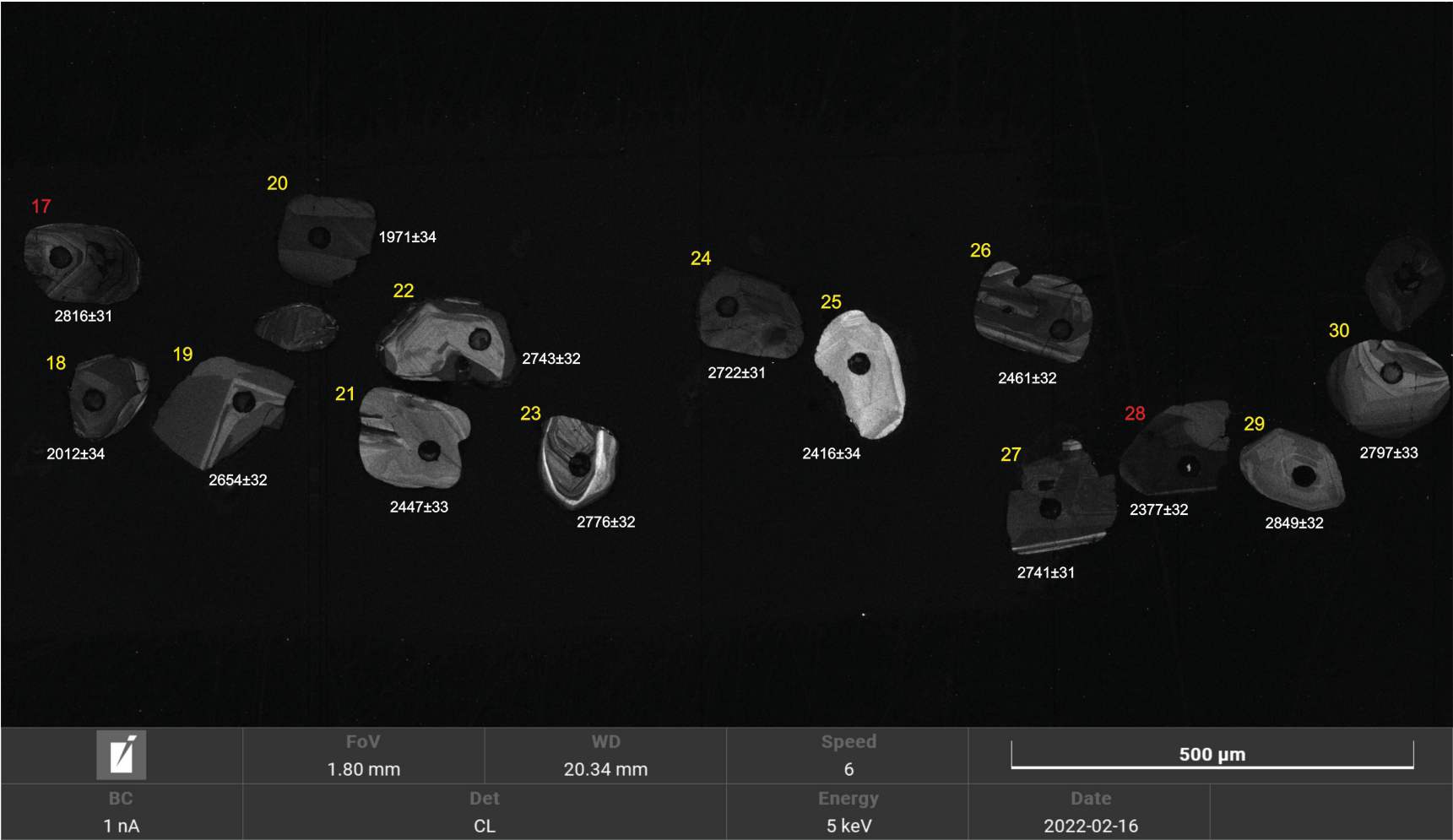
Карта U-Pb LA-ICP-MS датирования зерен циркона песчаников Ивановского грабена Кольского п-ова на основе катодолюминесцентных изображений CL images of analysed zircon grains from the Ivanovsky graben sandstones (the Kola Peninsula) with the values of corresponding U-Pb LA-ICP-MS age
