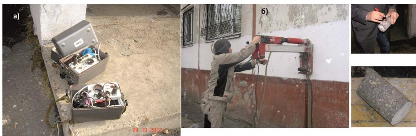
Рис. 6. Отбор образцов-кернов для прочностных испытаний бетона наружной стены.
