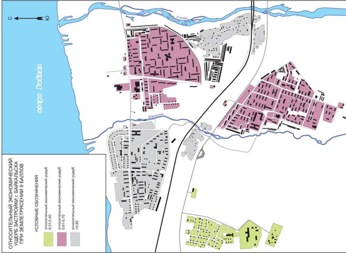
**Рис. 16.** Карта сейсмического риска г. Байкальска. Относительный экономический ущерб застройки при землетрясении интенсивностью 9 баллов.
