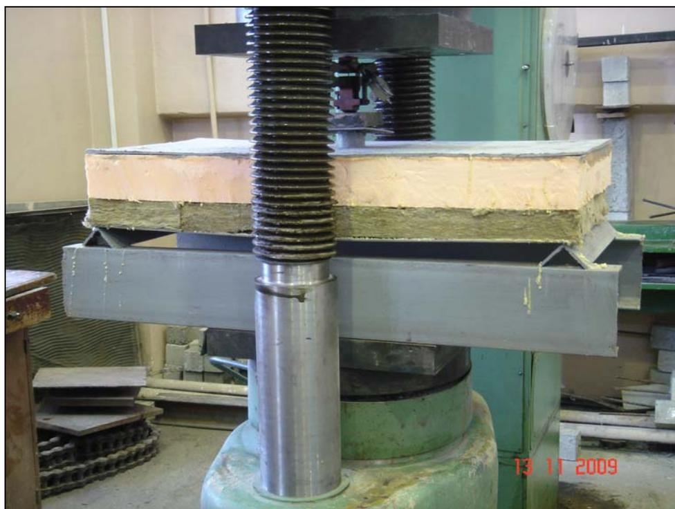
**Рис. 3.** Прочностные испытания фрагмента покрытия ЛД «Ермак» в лаборатории ИргТУ (Д.В. Киселев).
