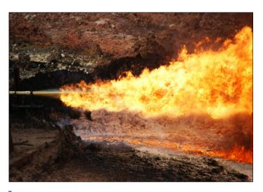
**Рис. 11.** Отработка скважины с ГС – 1000 м на факельный амбар после бурения (с кольматацией). Очистка скважины. Юрубченская залежь. Внизу видна горящая дорожка кольматанта [Vakhromeev et al., 2014].
