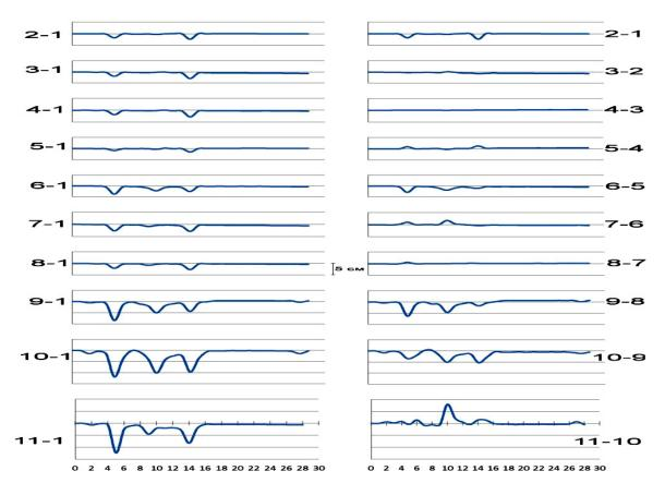
**Рис. 19.** «Эволюционные» (слева) и «пульсационные» (справа) графики изменений превышений вертикальных отметок реперов.
