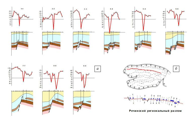
**Рис. 6.** Распределение современных вертикальных смещений земной поверхности по профилям, организованным вдоль простирания Речицкого разлома (a) и местоположение нивелирных профилей ( $\delta$ ).
