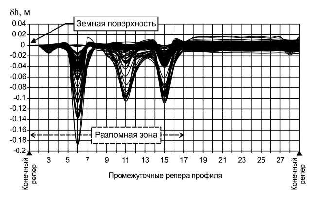
**Рис. 13.** Распределение вертикальных смещений земной поверхности на нивелирном профиле относительно первого репера (Камчатка).
