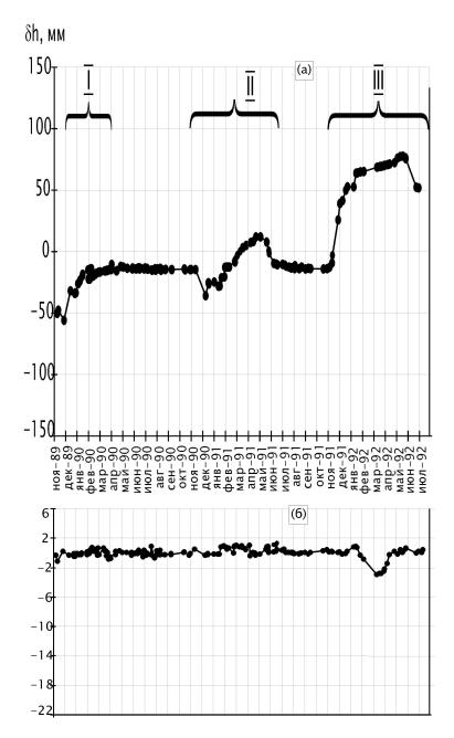
**Рис. 12.** Временной ход вертикальных смещений земной поверхности (Камчатка): a – «приразломная» секция;  $\delta$  – «бортовая» секция.
