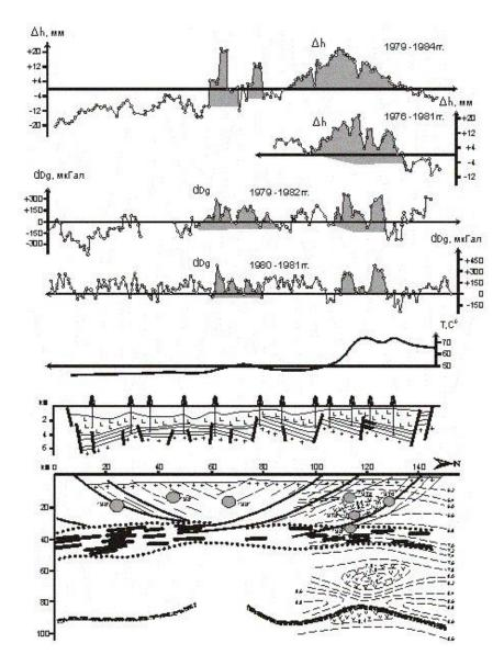
**Рис. 2.** Современные вертикальные движения земной поверхности и изменения силы тяжести во времени по региональному сейсмическому профилю ГСЗ МОВЗ VIII – VIII через Припятский прогиб.
