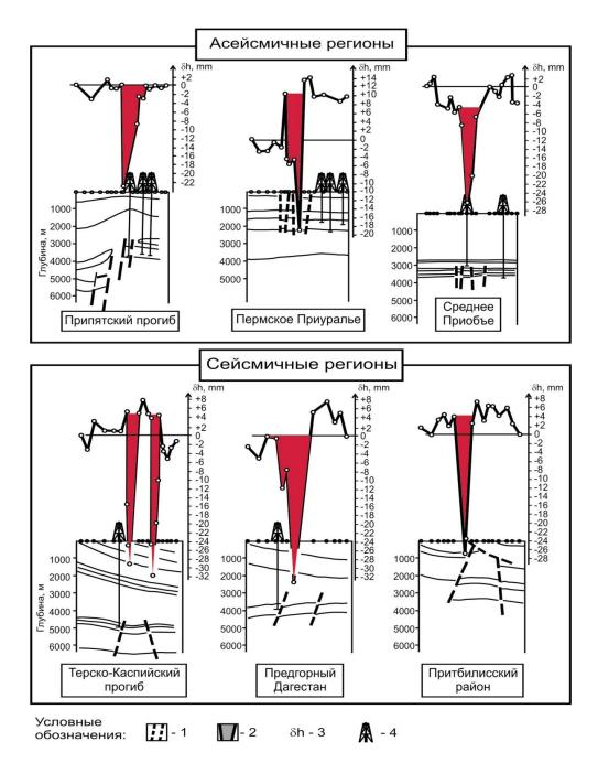
**Рис. 4.** Примеры локальных аномалий современных вертикальных движений земной поверхности типа для различных регионов.
