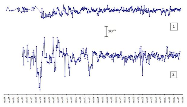
**Рис. 11.** Временной ход горизонтальных движений земной поверхности (Копетдагский регион): *1* – светодальномерная линия L 3330; *2* – светодальномерная линия L1532.
