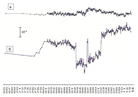
**Рис. 9.** Временной ход вертикальных смещений земной поверхности (Копетдагский регион): a – «бортовая» секция (l=4 км);  $\delta$  – «приразломная» секция (l=0.6 км).
