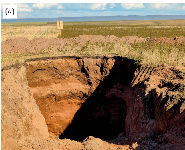
Рис. 5. Вид карстово-суффозионного провала (19.09.2024 г.): (а) – обзорная фотография провала; (б) – ортофотоплан участка (по данным БПЛА).
