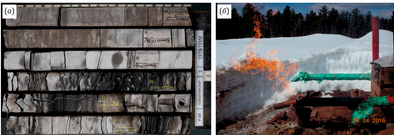
Рис. 3. Бильчирский горизонт-коллектор ангарской свиты: (а) – керн трещинно-поровый, трещинно-порово-кавернозный, трещинный; (б) – выброс газа на Ковыктинском ГКМ. Сквжина Квт-74 [Gorlov et al., 2016].
