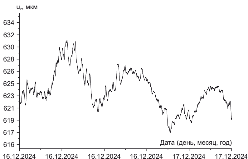
Рис. 5. 12-часовые вариации перемещений, обусловленных лунно-солнечными приливами.
