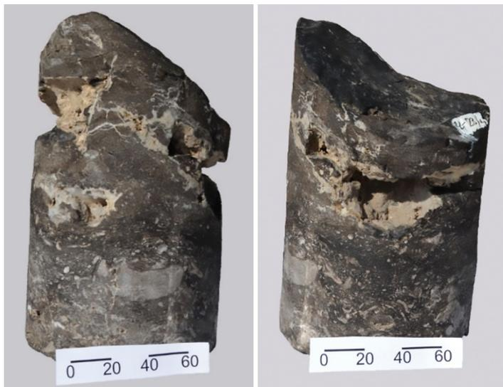
**Рис. 6.** Наклонная трещина тектонического отрыва в катаклазированном известняке (деталь рис. 5, в) с последующим развитием кавернозности и новообразованиями карбонатных минералов.
