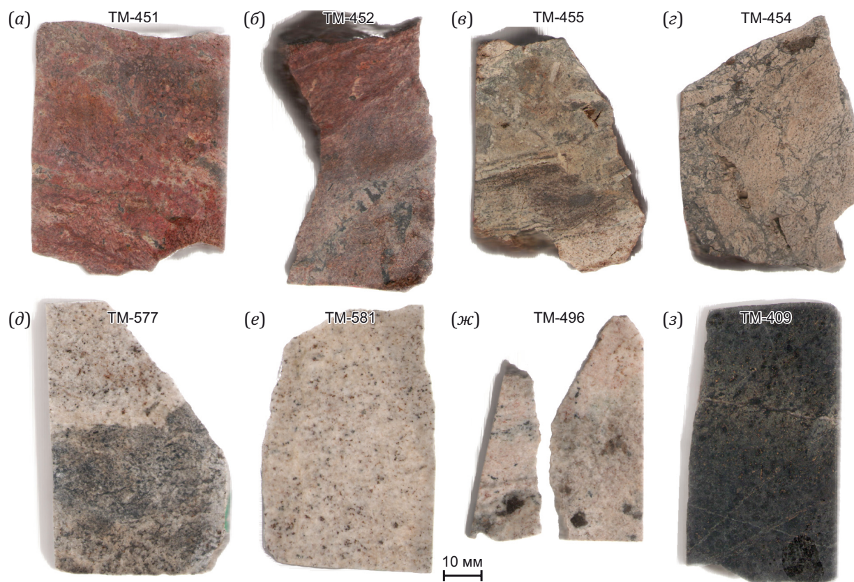
Рис. 2. Общий вид образцов редкометалльных (анкеритовых) карбонатитов (скв. 4849) (а–г), фосфорно-редкометалльных (полиминеральных) (скв. 4041) (д–ж) и апатит-микроклин-биотитовых (кальцит-анкеритовых карбонатитов или микроклин-слюдистой карбонатной породы) (з).
