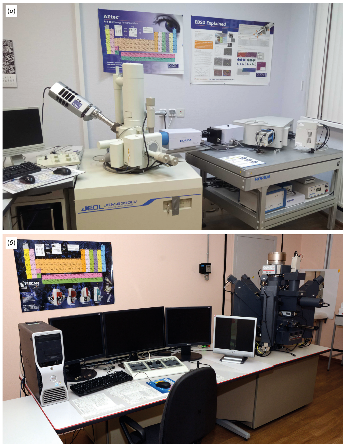
Рис. 2. Электронный микроскоп JSM 6390LV (а) и микроанализатор Cameca SX100 (б).
