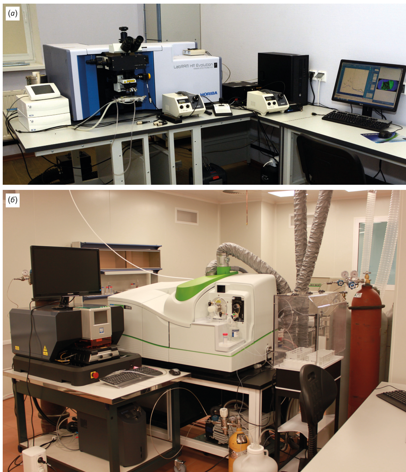
Рис. 3. Рамановский спектрометр Horiba LabRam HR800 Evolution (а) и масс-спектрометр NexION 300S с приставкой для лазерной абляции NWR 213 (б).
