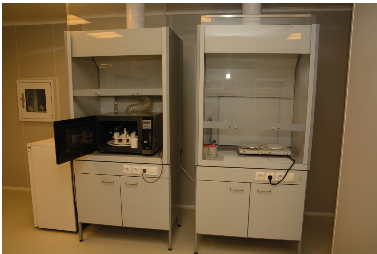
Рис. 4. Оборудование для химического автоклавного (микроволнового) разложения твердых проб, очистки воды и кислот в блоке чистых помещений класса 6.
