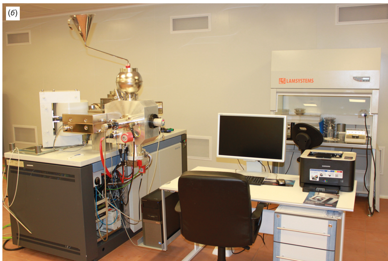
Рис. 5. Многоколлекторные масс-спектрометры Triton Plus (а) и Neptune Plus (б) в блоке чистых помещений класса 7.
