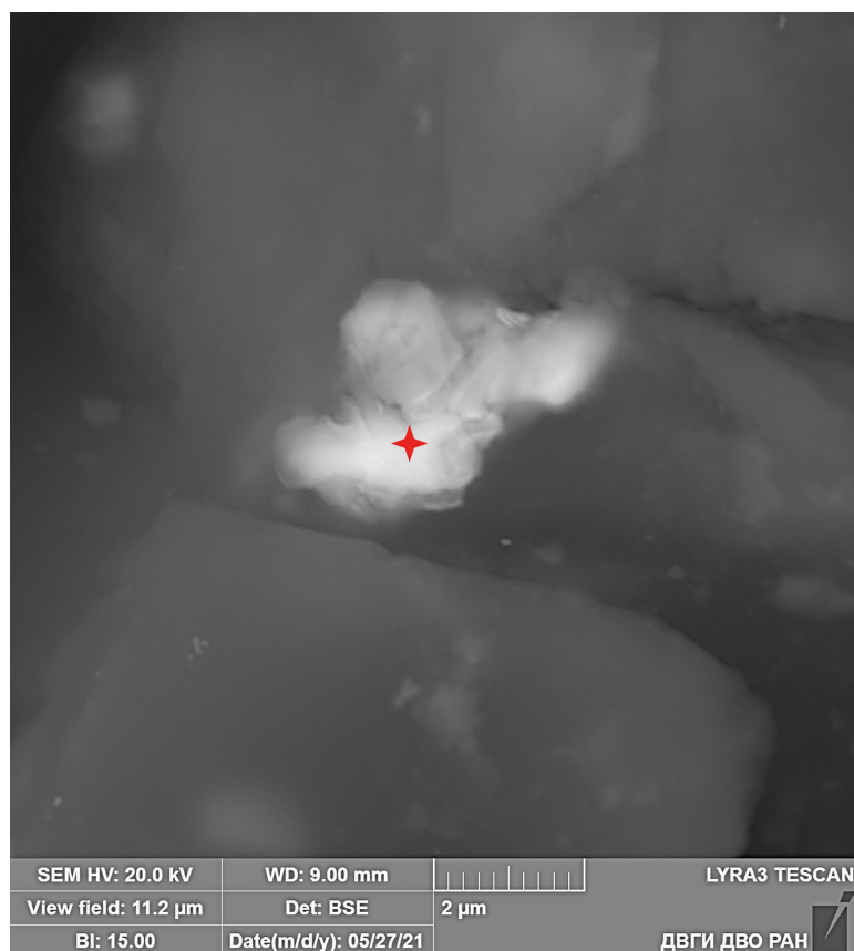
Рис. 1. Зерно интерметаллида Fe(Ni,Cu), зафиксированное в алюмосиликатном остатке пробы ЖМК разлома Сикейрос методом СЭМ с ЭДС-спектрометрией.
