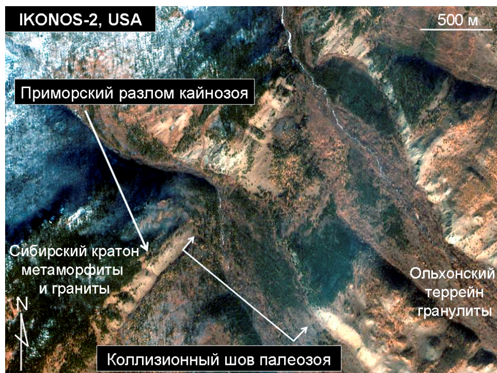
Рис. 18. Космический мультиспектральный снимок со спутника IKONOS-2, разрешение 4 м/пиксель. На дистанционных изображениях высокого разрешения коллизионный шов определяется без труда. На снимках такого масштаба отчетливо видны и современный Приморский разлом, и коллизионный шов раннего палеозоя.
