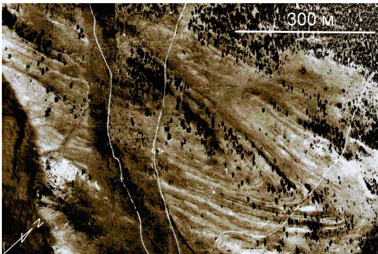
Рис. 20. Складки на аэрофотоснимке масштаба 1:5000. Структуры сложены бластомилонитами по раннепалеозойским породам. Наклон шарниров около 65°. Степень обнаженности весьма велика, но неравномерна по площади этого участка. Степень дешифрирования – суперкласса. Уменьшено по сравнению с оригиналом.
