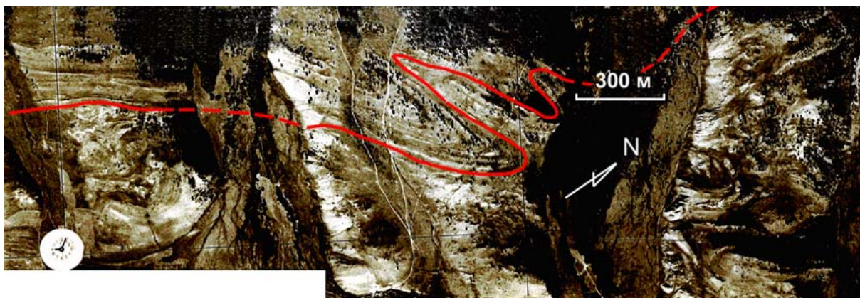
Рис. 19. Аэрофотоснимок масштаба 1:12000. Верховья р. Кучелги. Верхняя часть снимка – зона коллизионного шва (бластомилониты по породам раннего палеозоя). Нижняя часть снимка – раннепалеозойские гранулиты Чернорудской зоны. В 500 м за верхним краем снимка – Сибирский кратон. Красная линия – граница коллизионного шва и гранулитов Чернорудской зоны Ольхонского террейна. На снимке хорошо дешифрируется серия крупных складок с крутыми шарнирами, локализованная в бластомилонитах эпидот-амфиболитовой фации по палеозойским гранулитам террейна.
